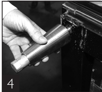
4 Rolle in die Schiene an der Schrankunterseite einführen.
