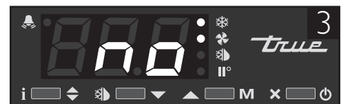
Bild 3: Wenn am Bedienteil „no“ angezeigt wird, ist der Regler entsperrt.
